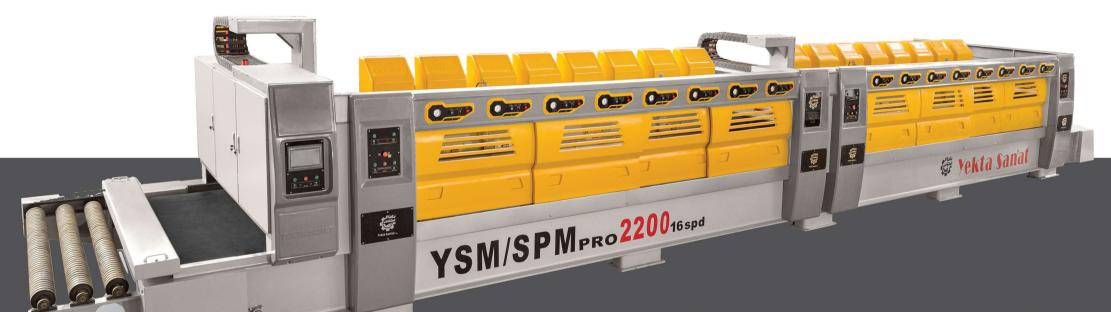
دستگاه اسلب ساب تمام اتوماتیک یکتاصنعت با داشتن دو گهواره مستقل از هم برای ساییدن سنگ تا عرض ۲۱۰۰ میلیمتر طراحی شده است. از مزیت های این دستگاه می توان به کاهش ارتعاشات، عملکرد آرام، مصرف بهینه ساینده ها و افزایش راندمان اشاره کرد.
