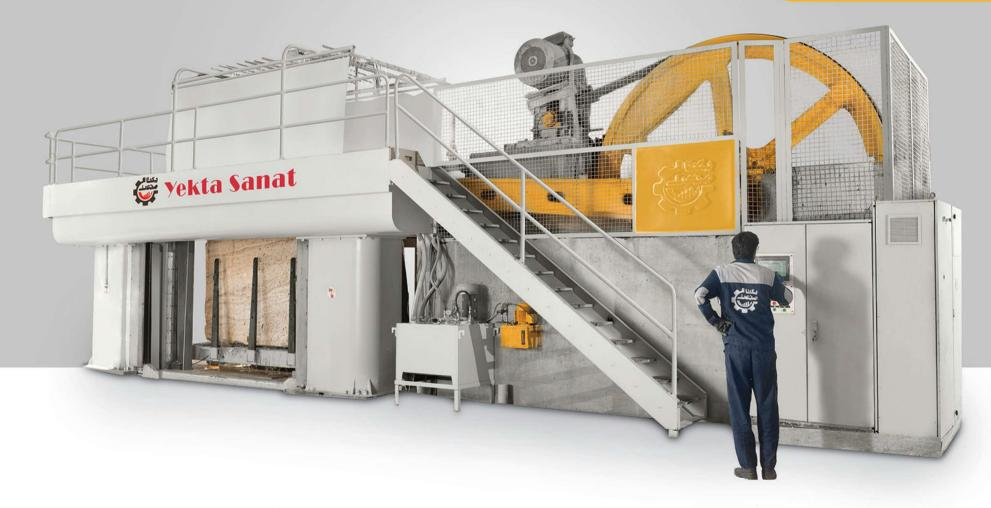
اره ی اسلب بُر یکتا صنعت برای برش کوپ های ماربل طراحی و ساخته شده است. در این دستگاه تیغه ها در ارتفاع ثابتی قرار گرفته و عملیات برش با بالا رفتن بلوک سنگ به سمت قفسه تیغه ها انجام می گردد.
