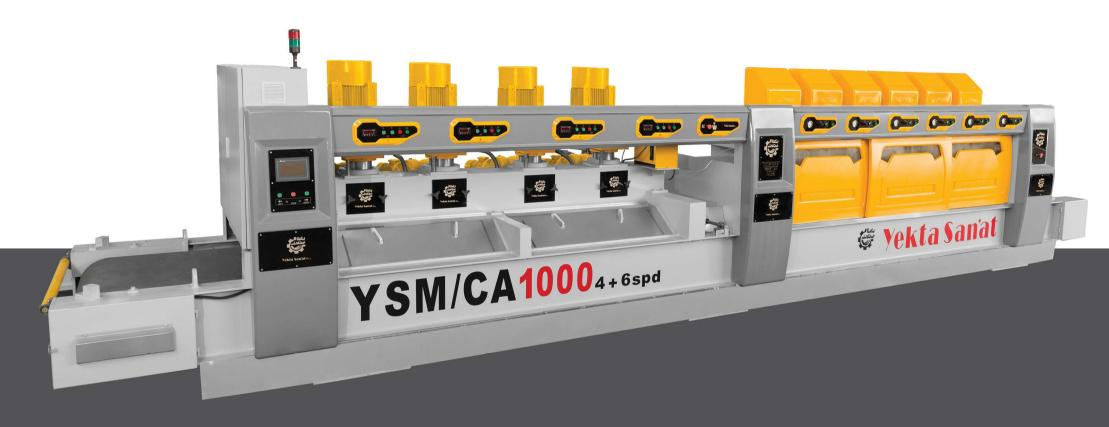
دستگاه کالیبر اتوماتیک یکتاصنعت از دو بخش محور های الماسه و محورهای ساینده تشکیل شده است. ضخامت سنگ های خروجی این دستگاه تا ۰.۲ میلیمتر دقت دارد و قادر است خطای برش تا ۴ میلیمتر در ضخامت را اصلاح کند. بسته به نوع سنگ ، متراژ تولید خواسته شده و خطای سنگ های بریده شده این دستگاه در مدل های مختلف تولید و عرضه می گردد.
