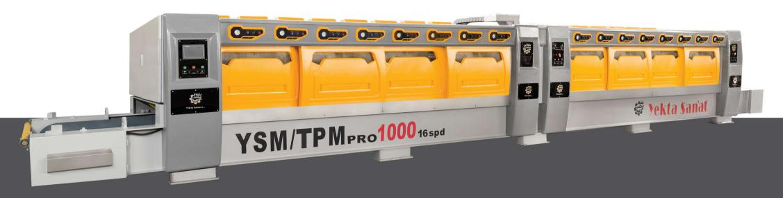
دستگاهای ساب تایل ماربل یکتاصنعت با داشتن دو گهواره مستقل از هم برای پولیش دادن سنگ های تایل تا عرض ۲۰۰ میلیمتر طراحی و ساخته شده است . دو گهواره بودن این دستگاه باعث کم شدن خیز وسط گهواره شده که علاوه بر کاهش ارتعاشات گهواره، کیفیت ساب و کاهش مصرف ساینده ها را به همراه دارد. بسته به نوع سنگ، متراژ سنگ خواسته شده و کیفیت سنگ های کالیبر شده در ورودی ، تعداد محور های دستگاه متفاوت می باشد. همچنین این دستگاه مجهز به سیستم پی ال سی پیشرفته و برنامه نویسی کاربردی با کاربری آسان است.
