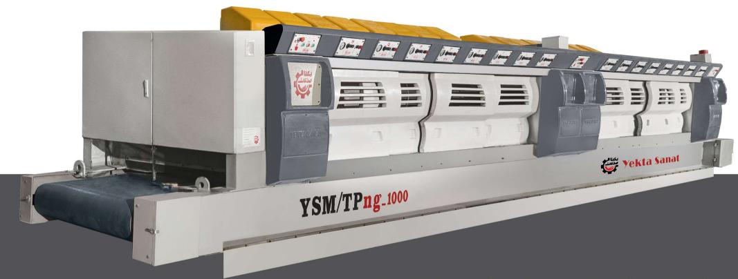
دستگاهای ساب تایل گرانیت یکتاصنعت با داشتن دو گهواره مستقل از هم برای پولیش دادن سنگ های تایل تا عرض ۲۰۰ میلیمتر طراحی و ساخته شده است . دو گهواره بودن این دستگاه باعث کم شدن خیز وسط گهواره شده که علاوه بر کاهش ارتعاشات گهواره، کیفیت ساب و کاهش مصرف ساینده ها را به همراه دارد. بسته به نوع سنگ، متراژسنگ خواسته شده و کیفیت سنگ های کالیبر شده در ورودی ، تعداد محور های دستگاه متفاوت می باشد. همچنین این دستگاه مجهز به سیستم پی ال سی پیشرفته و برنامه نویسی کاربردی با کاربری آسان است .
